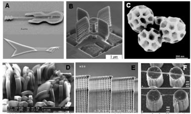
Figure 11. (A) Nano-guitar<sup>5</sup>, (B) nano rotor<sup>6</sup>, (C) DNA buckyball<sup>7</sup>, (D) nanotubes<sup>8</sup>, (E) nanonails<sup>9</sup>, (F) nano airbridge<sup>10</sup>
